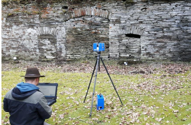
Abb. 9 Laserscanning an der Bleihütte in Ramsbeck
